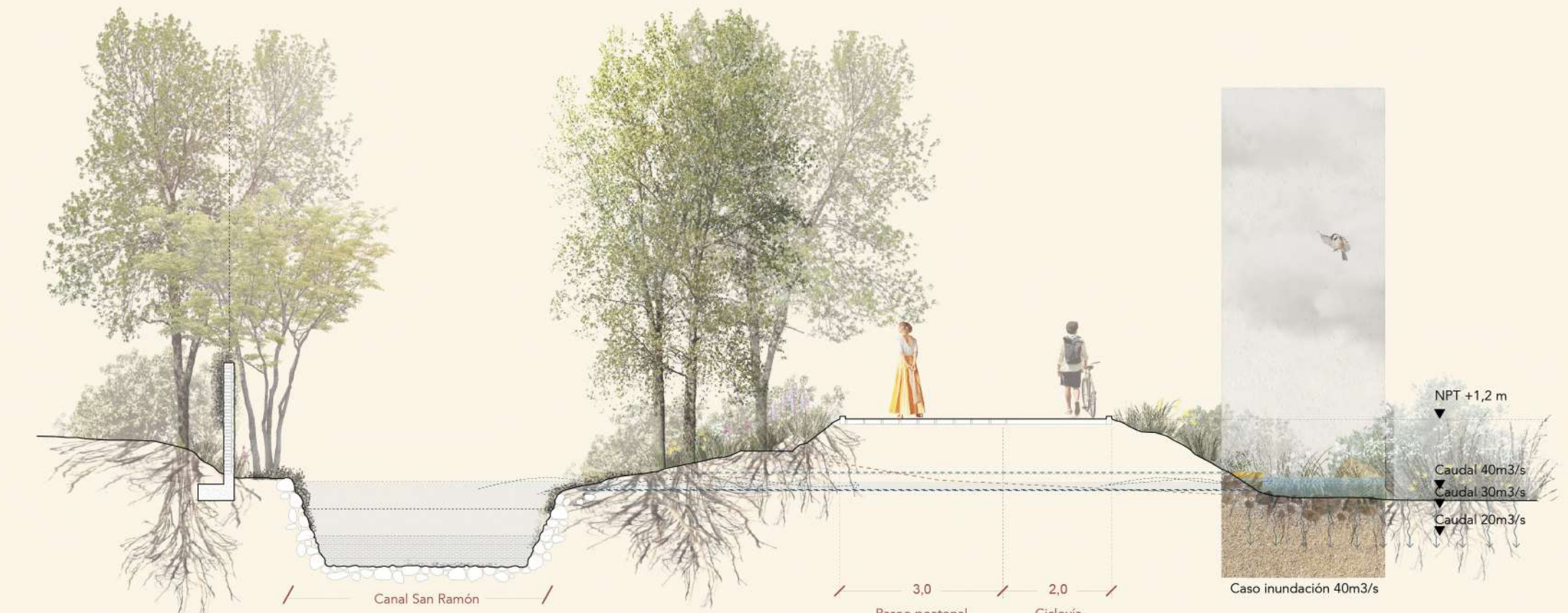
CORTE PASEO DE LA QUEBRADA ESC 1:100
